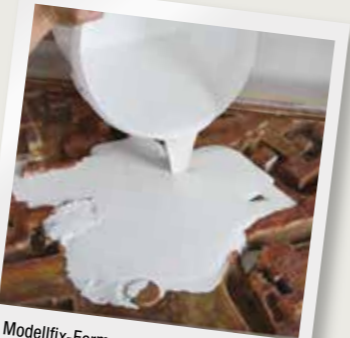
Modellfix-Form mit Gießmasse ausgießen.
