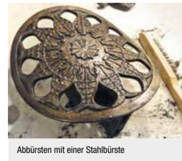
Abbürsten mit einer Stahlbürste
