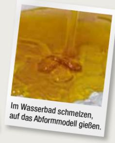
Im Wasserbad schmelzen, auf das Abformmodell gießen.
