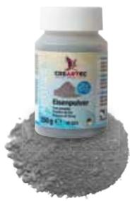
Verbrauch: 90 - 100 g/m<sup>2</sup> | Korngröße superfein: 100 µm | Korngröße mittelfein: 140 µm | Dichte: 7,86 g/cm<sup>3</sup>
