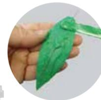
Aushärtezeit in Dekormatten: 5 h lufttrocknend | Aushärtezeit im Backofen: 30 min bei 50°C | Dichte: 1,1 g/cm<sup>3</sup>
